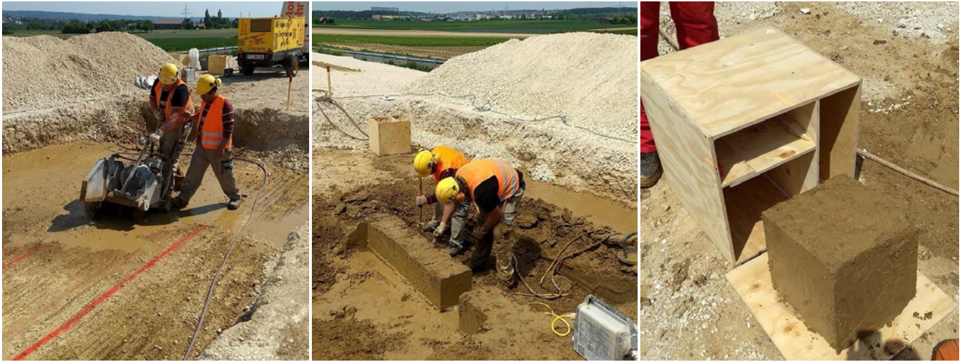
Abb. 1: Probenahme und Transportbehälter der Bodenproben. Links: Ausführung von Sägeschnitten entlang der Schnittlinien, Mitte: Freilegung der würfelförmigen Probekörper, Rechts: Verpackung und Sicherung der Probekörper in Transportkisten
